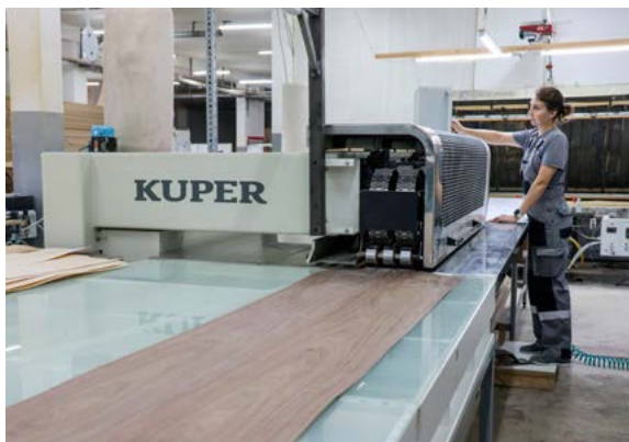
Сращивание шпона на итальянском оборудовании.
