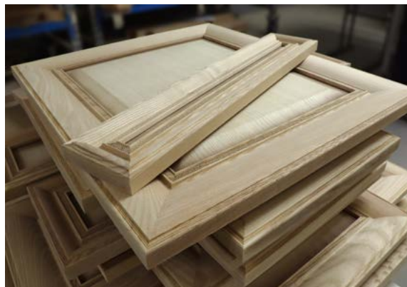
Участок шлифовки фасадов перед процессом окрашивания.
