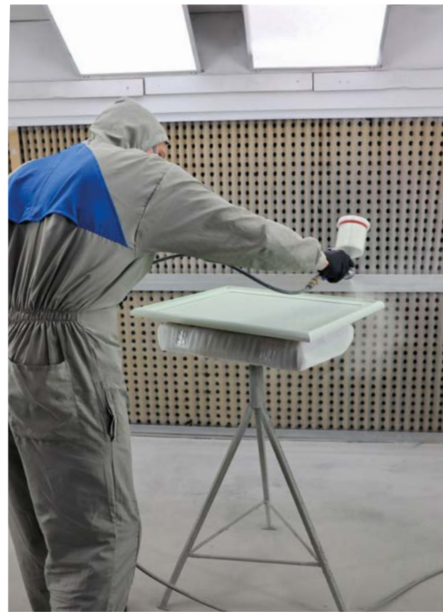
Окрашивание фасада в малярной камере.
