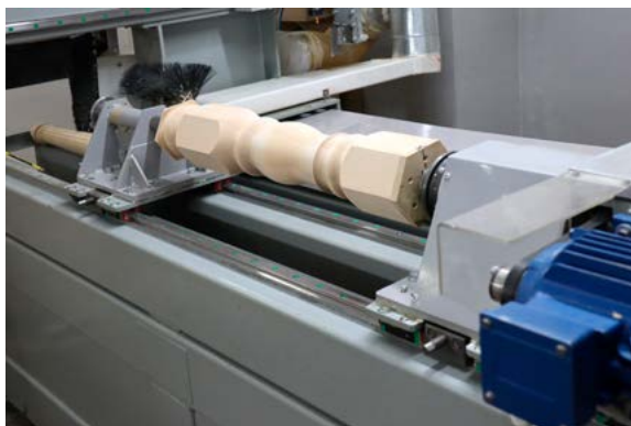
Процесс изготовления заготовки ноги для стола Палермо на токарном станке ЧПУ по дереву.
