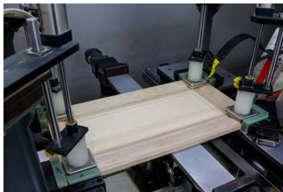
Сборка заготовки фасада из массива с использованием станка ТВЧ.
